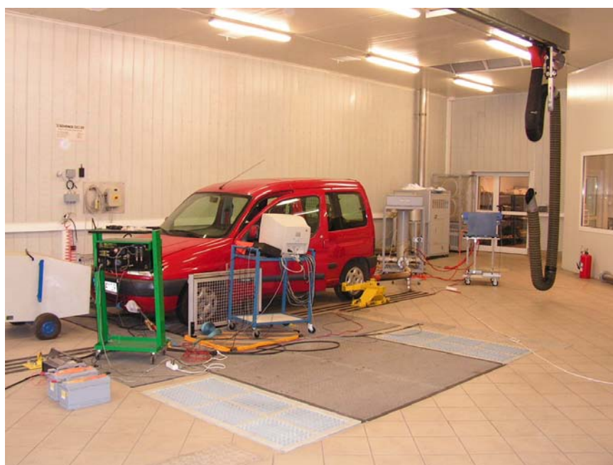
Rys. 1. Samochód Citroën Berlingo na stanowisku hamowni podwoziowej Fig. 1. Research vehicle Citroën Berlingo on chassis dynamometer
